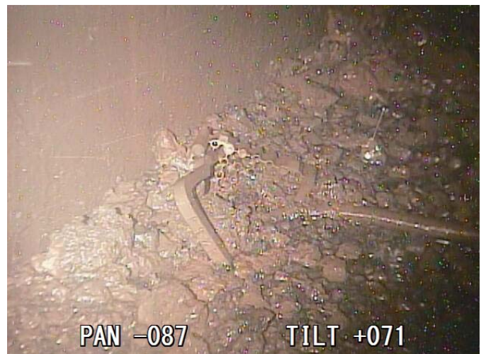
2号機の格納容器の底—L字型の燃料集合体のハンドル (TEPCO)
