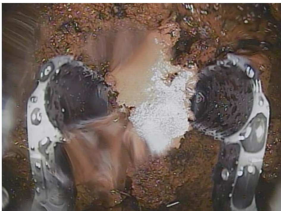
2号機の格納容器－「フィンガー」で堆積物を摘まむ（TEPCO）
