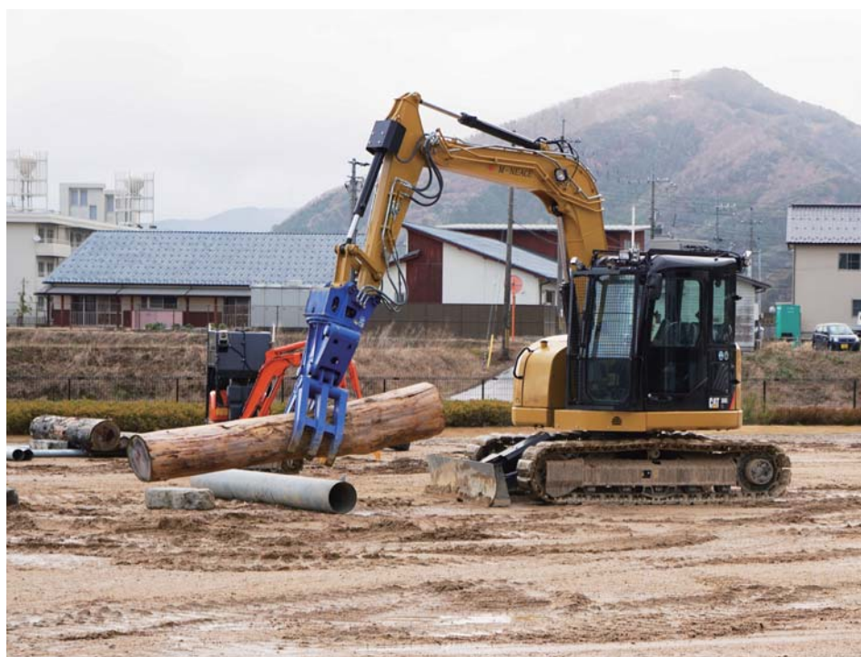
作業用重機は遠隔操縦で100kgの瓦礫を掴み、運ぶことができる
