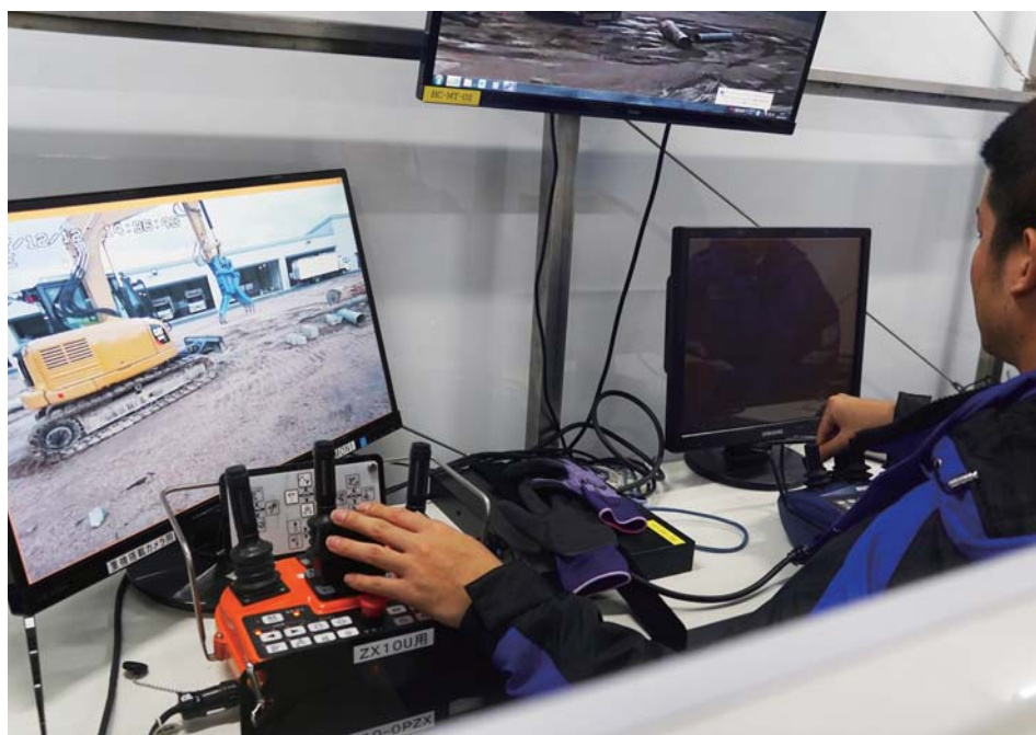
コントロール車の中から画面を見ながら重機の遠隔操作をする
