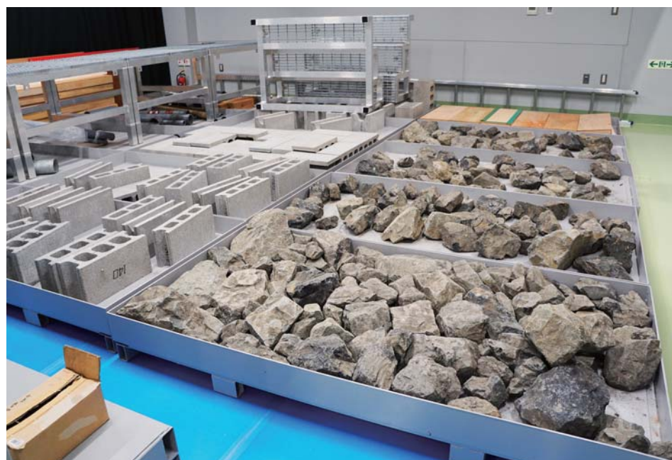
色々な地面環境でのロボットの走行テスト、操縦の習熟を行う
