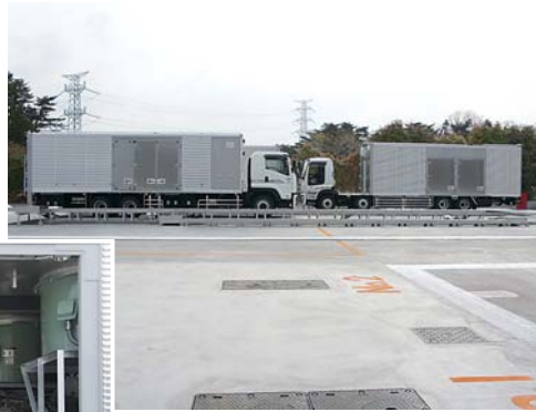
電源車、ガスタービン発電車は月1回運転確認を行っている。
