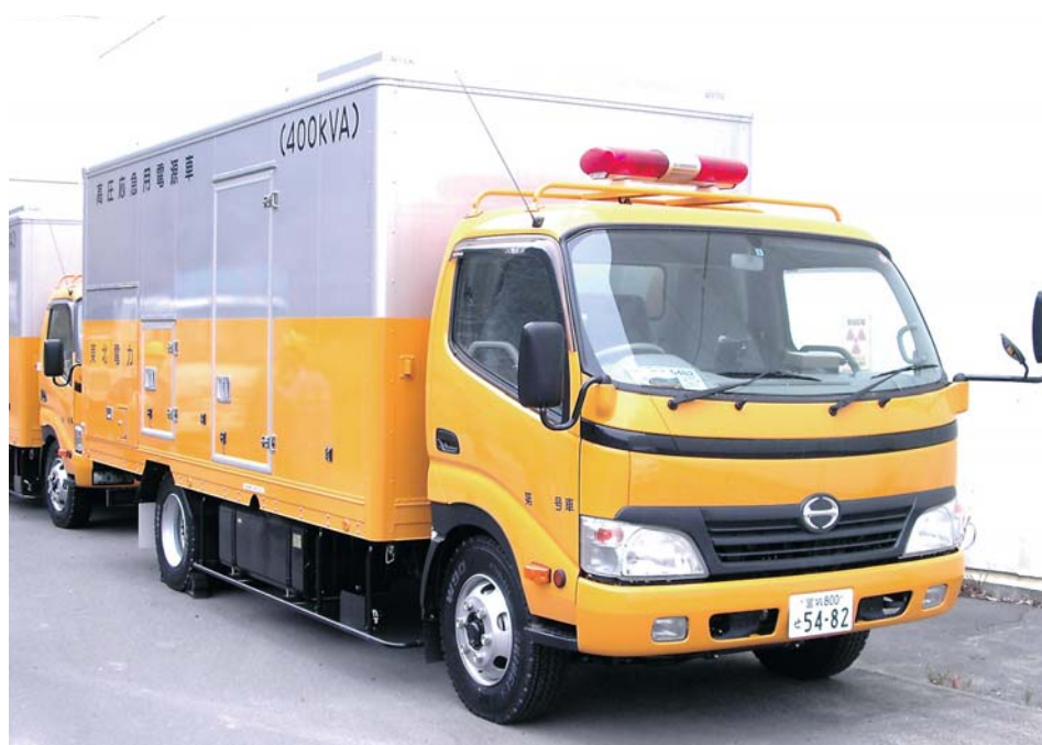
新調された電源車（東北電力提供）
