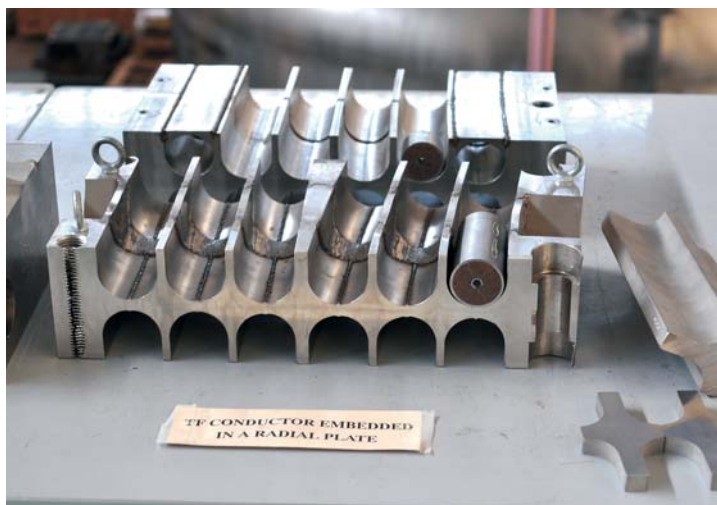
超伝導ケーブルを束ね支える支持構造物（切り出した一部）
