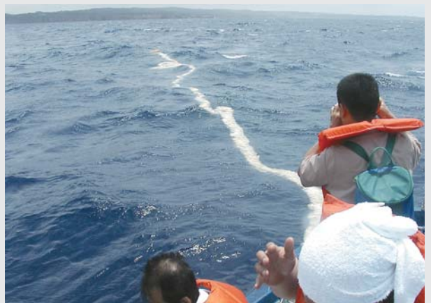
恩納村での試験： もこもこの長いマフラーのようなモール状の捕集材
