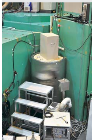
生体高分子用中性子回析装置 BIX-4 (中央の円筒形)
