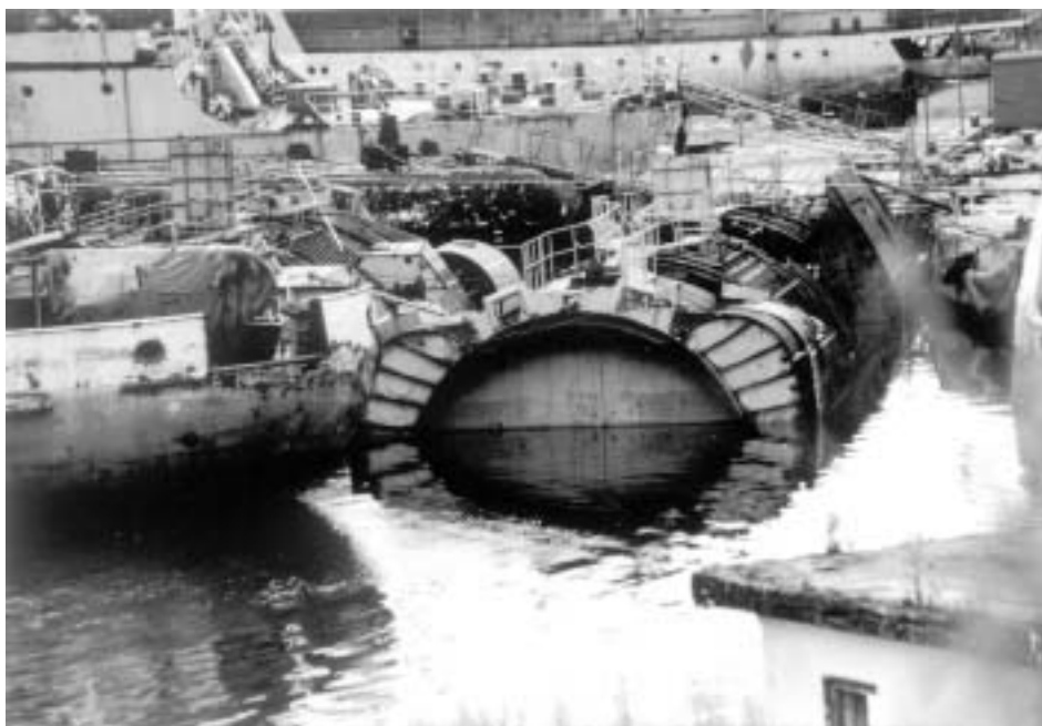
原子炉室の両端に隔壁をつけて、港に浮かしている。(1995年撮影)
