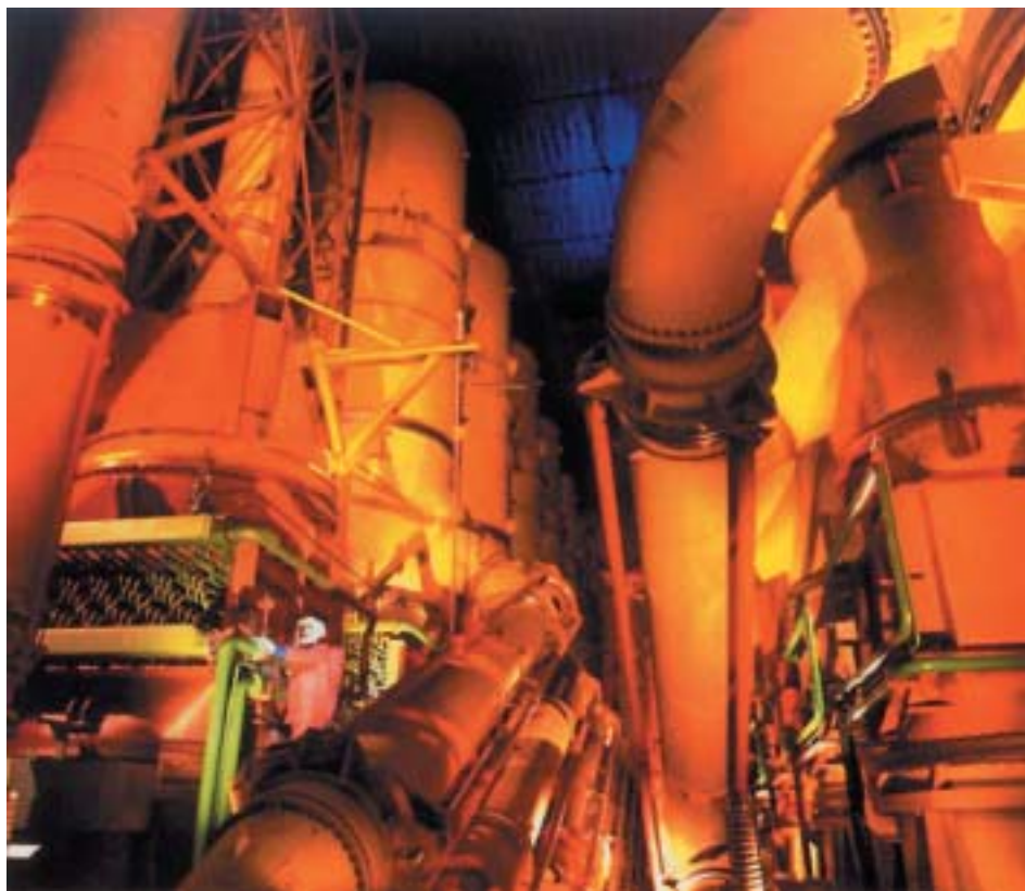
EURODIF ガス拡散濃縮カスケード（COGEMAパンフレットより）
