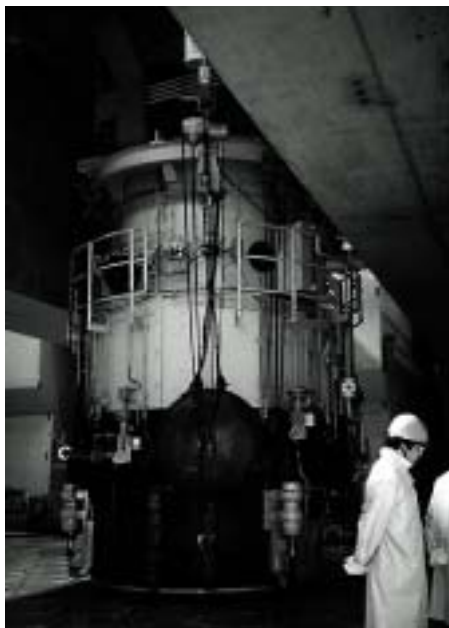
黒鉛ブロック燃料用交換機（独製）
